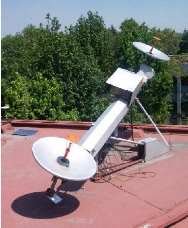
Figura 1: El Radio Interferómetro Solar de Base pequeña del Instituto de Geofísica, de la UNAM
